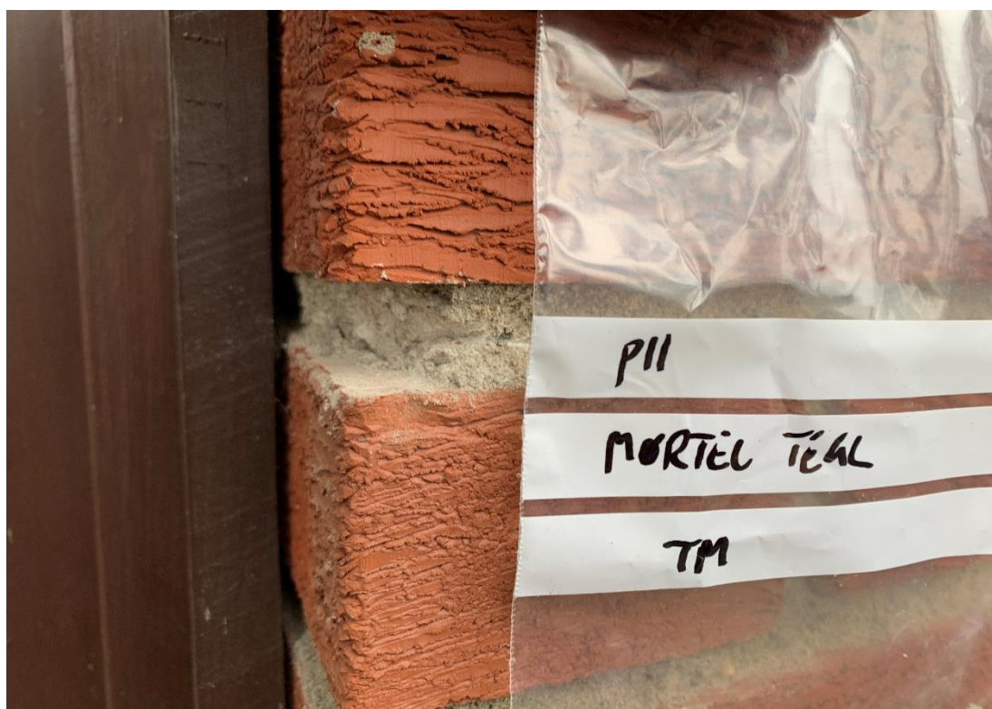
Bilde 10 – Bildet fra prøve 11. Mørtel fra teglforblendingen ble analysert for tungmetaller. Prøven viser en forekomst av tungmetaller under normverdi for forurensete masser. Teglsteinen kan håndteres som rene masser.
