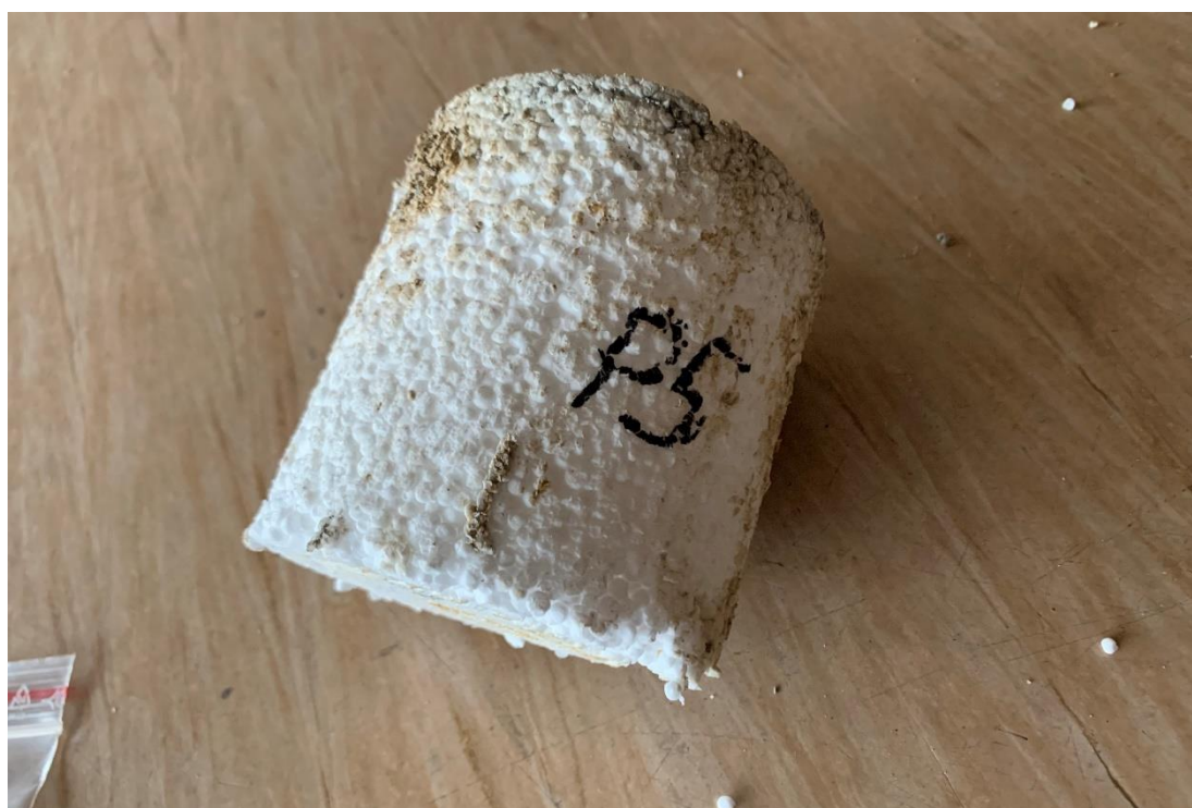
Bilde 4 – Bilde fra prøve 5. Isopor isolasjon på mark ble analysert for bromerte flammehemmere. Prøven viser ingen forekomst av bromerte flammehemmere. Isoporen kan leveres som ordinært avfall.
