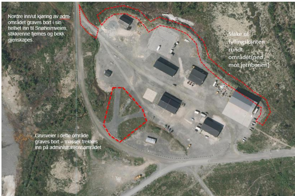
Figur 3: Terrengarbeider i forbindelse med administrasjonsområdet
