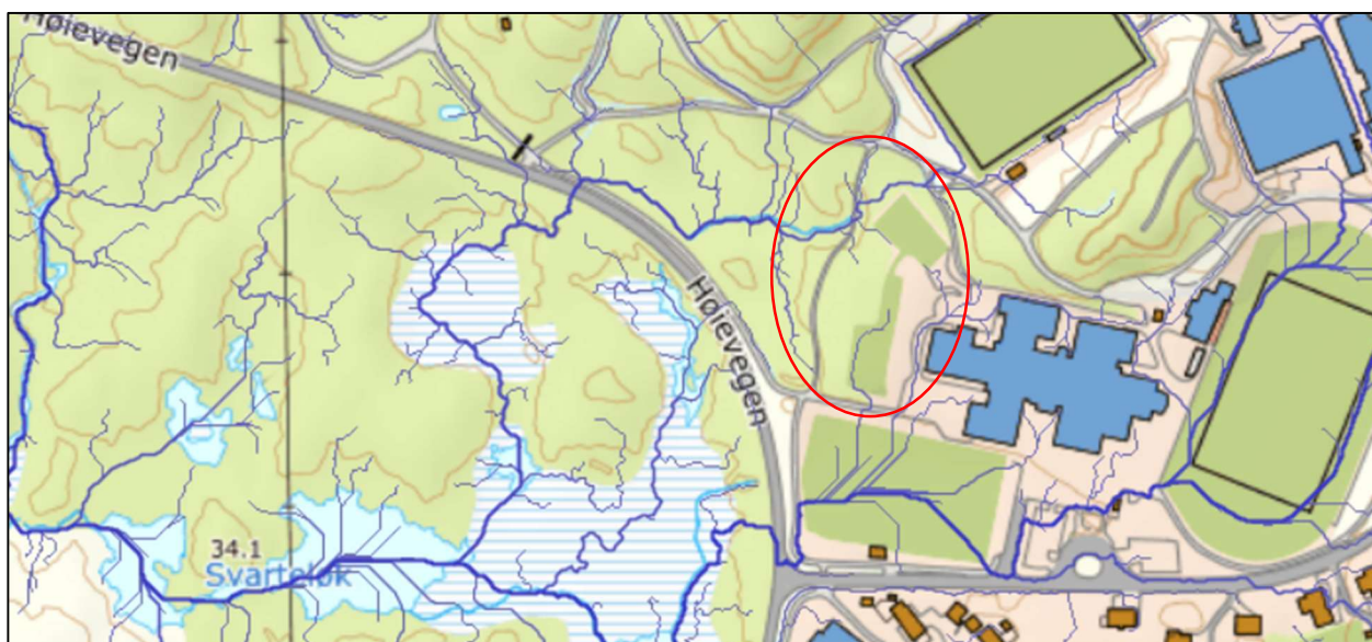
Figur 4 Avrenningslinjer for urban flom, Kilde: Scalgolive.no
