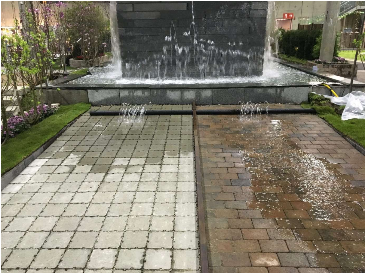
Figur 17 Permeabelt versus tett dekke. Foto: ASAK Miljøstein
