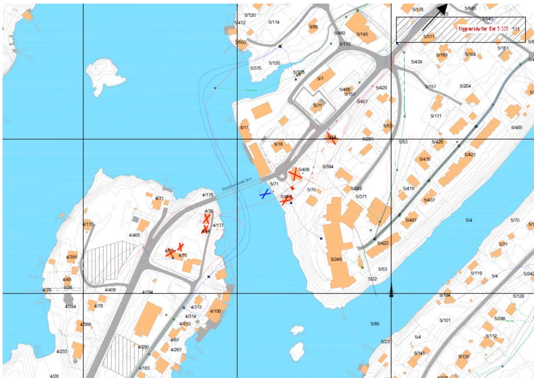
Figur 2 Plassering bygg og installasjoner som skal rives ifm. entreprise 1 (merket med kryss), samt forslag til plassering av riggplass (skraverte områder)
