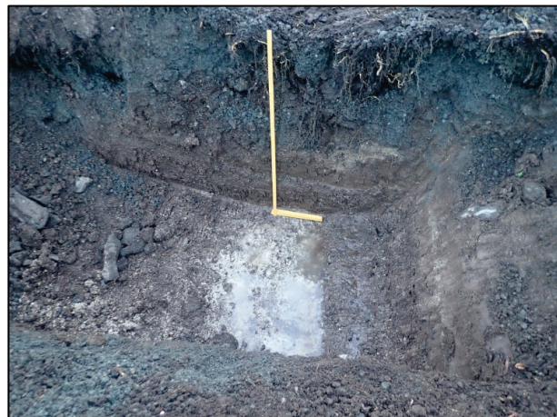
Figur 10: Prøvegrop HH-2, gressdekke over fyllmasse av grå finknust stein til ca. 0,4 meter. Torv ved 0,4 - 0,8 m, og skjellsand fra 0,8 m.
