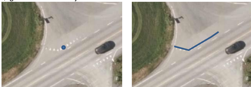
Figur 14. Eksempel: Vikelinje må minimum kartlegges som et punkt, men kan også leveres som en linje.
