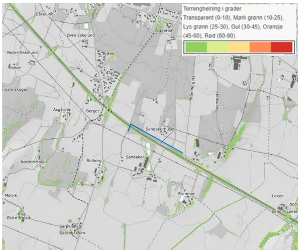
Figur 8: Utklipp fra Den Norske Høydemodell som viser, Terrenghelning i grader omkring Bane Nord. Prosjektområdet langs og under Bane Nord er markert med blå linje.
