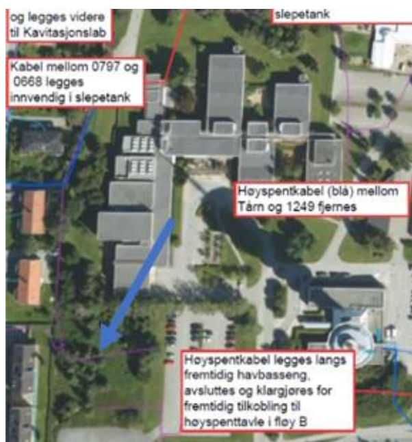
Figur 4. Identifisert høyspentkabel på tomten.
