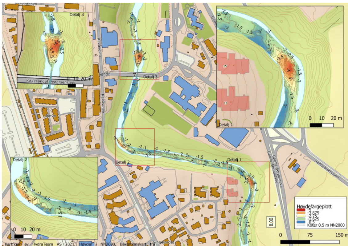
Figur 3-1 Resultater fra bunnkartlegging utført av HydraTeam 16.04.21. Figuren viser dybde av elven relativt til NN2000.
