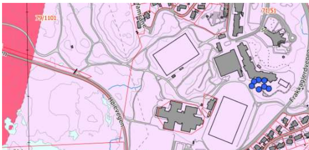
Figur 1 Berggrunnen i området består av migmatitt (lys rosa farge). Gjennomsnittlig varmeledningsevne for migmatitt og migmatiske gneiser er \sim 3,7 W/mK ( http://geo.ngu.no/kart/granada , Asplan Viak)
