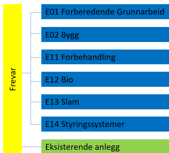
Figur 1 Prosjektnedbrytningsstruktur - PNS for Frevar. Hoveddelene merket med blått er omfattet av plan for systematisk ferdigstilling. Eksisterende bygg er ikke en del av prosjektet, men er tatt med i illustrasjonen pga delt toppsystem og avhengigheter mellom hoveddelene. Eksisterende anlegg må således hensyntas.
