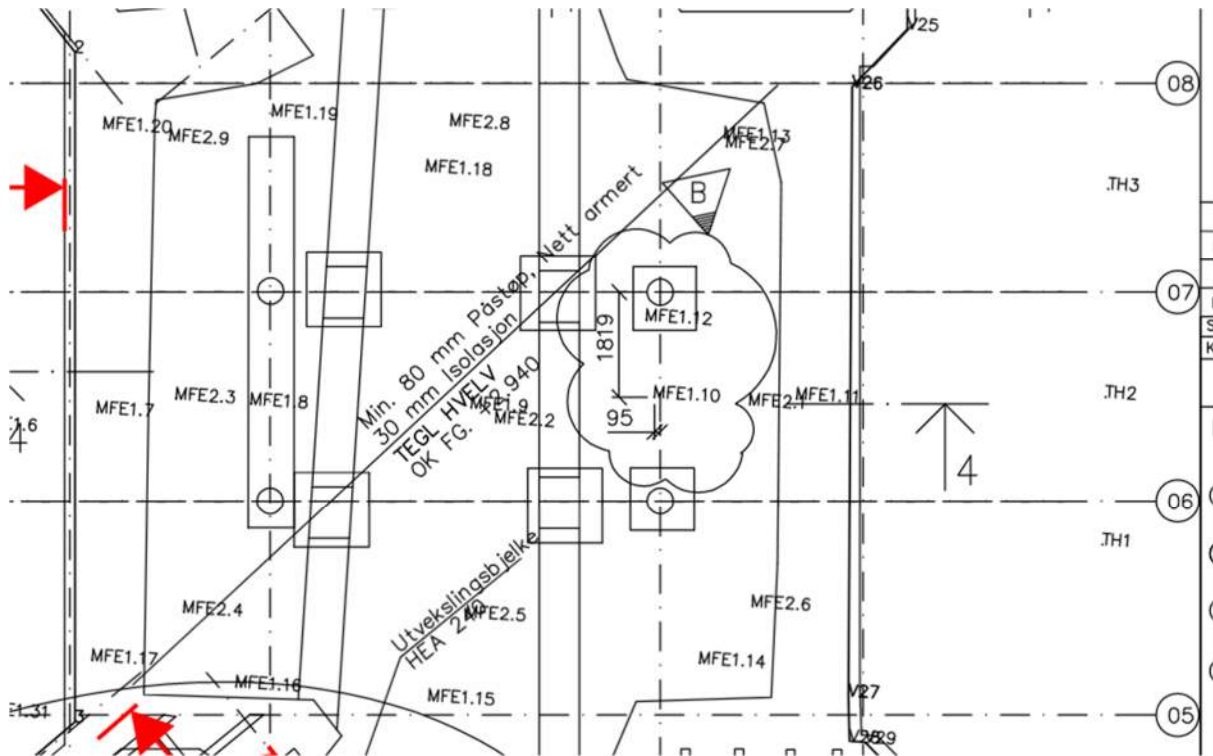
Figur 37 – Dekke over kjeller i vestibyle (B110, 2004)
