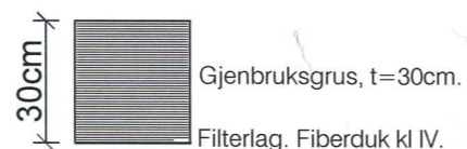
Stedlige masser Snitt M 1:20 Grus langs vegger (gjenbruk av grus under lek). Grus rundt "hoppesteiner"
