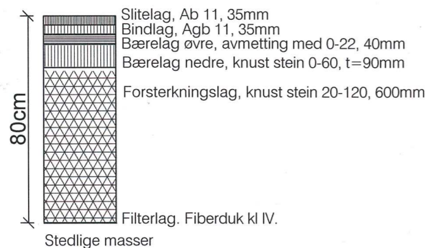
Snitt M 1:20 Asfalt, veger med kjøring.
