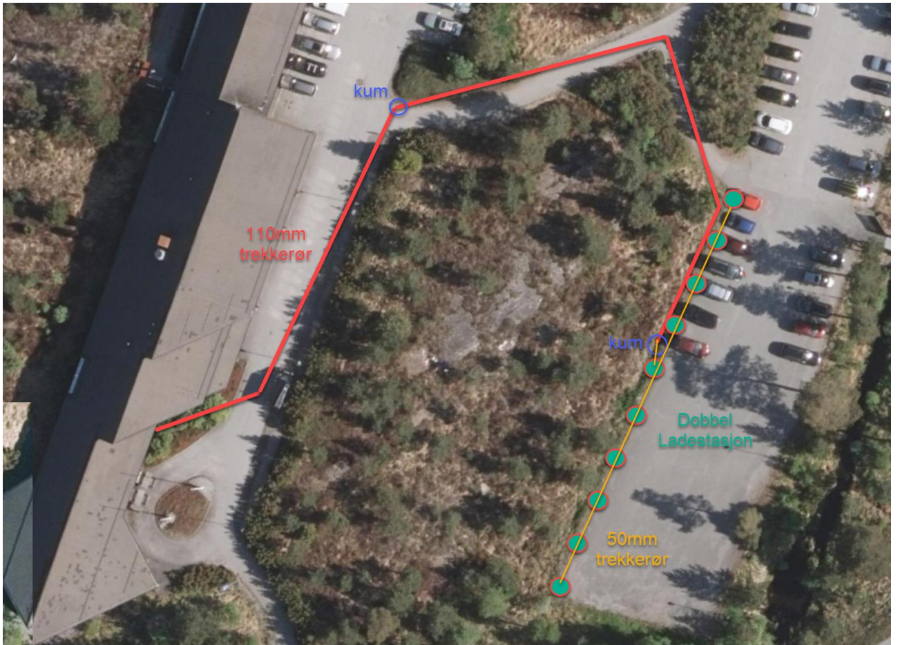
Skisse utvendig trekkerør/trekke-kummer og fundamentplassering
