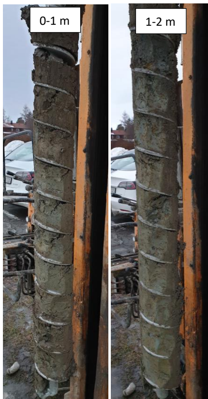
Figur 15: Prøvepunkt SK33. 0-1 m: grus og jord over antatt oppfylt leire. 1-2 m: leire. Foto: Multiconsult.
