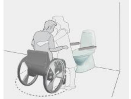
Forflytning fra rullestol på skrå inn forfra til toalett.
