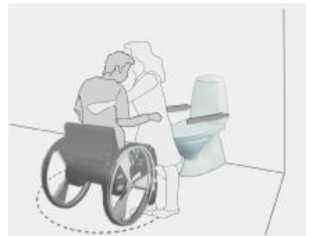
Forflytning fra rullestol på skrå inn forfra til toalett.
