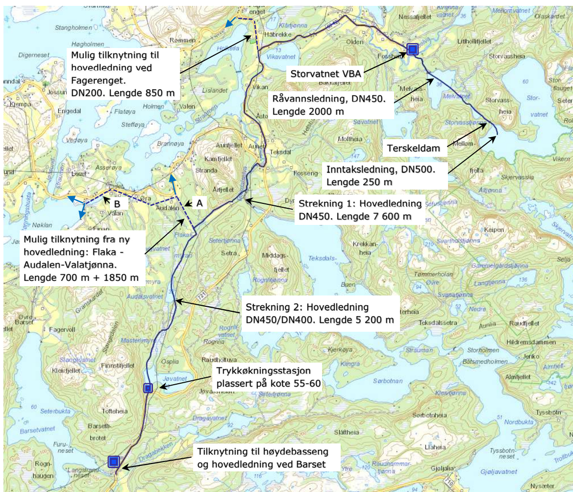
Figur 11: Vanninntak, vannbehandlingsanlegg og overføringslednign fra Storvatnet til Barset HB.
