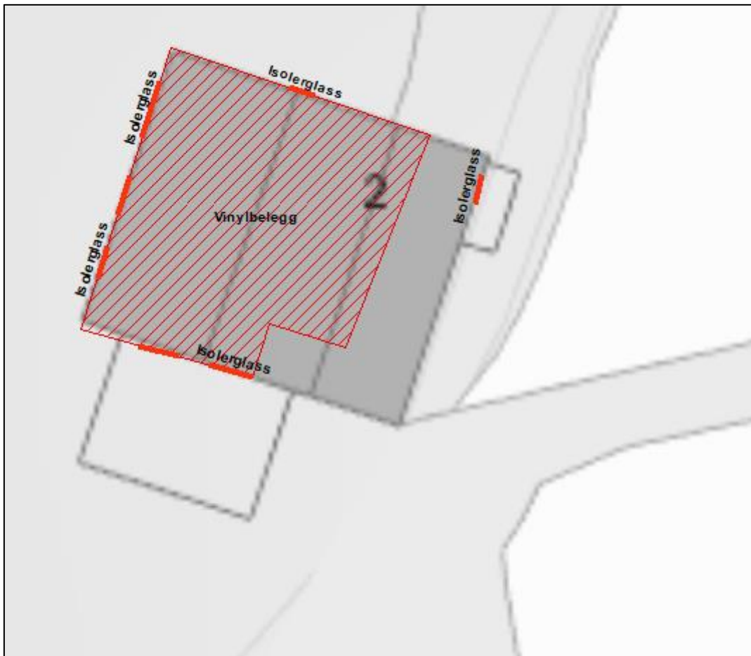
Figur 13 Kartutsnitt som viser forekomster av farlig avfall inne i kioskbygning.
