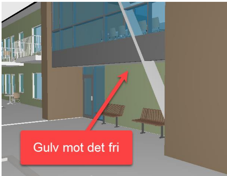
Figur 15: Gulv mot det fri i prosjektet.
