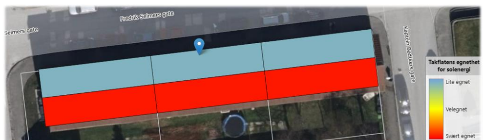
Figur 3-10 Takets egnethet for installasjon av solceller (solkart.no).
