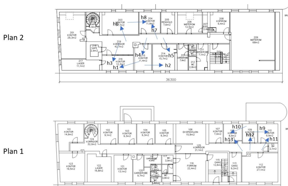
Figur 2. Markering av objekter for målinger av horisontal luftlydisolasjon
