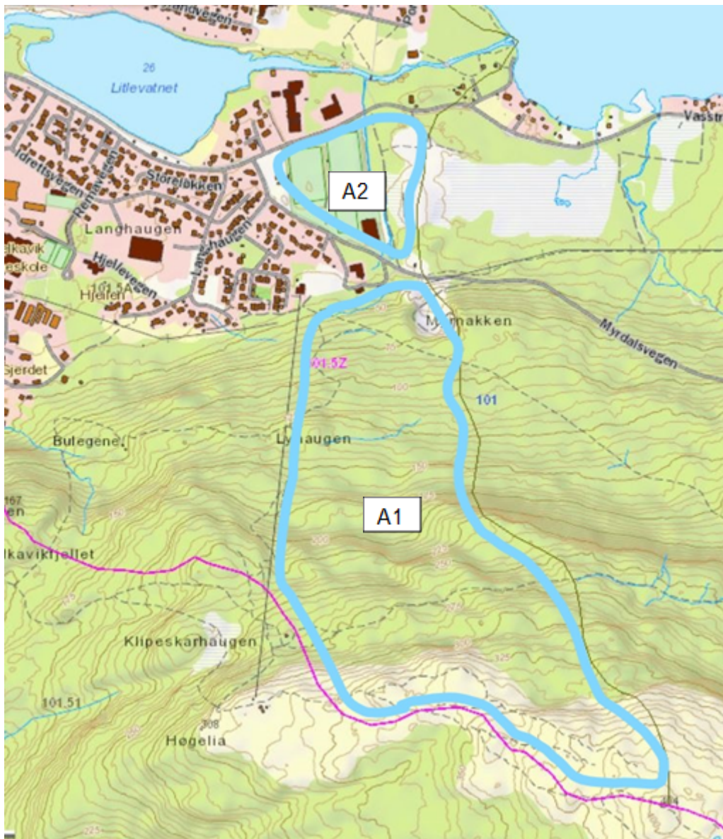
Figur 4 Tilrenning til bekk. A1 er området ovenfor Myrdalsvegen som går til bekk. A2 er dagens tilrenning fra planområdet til bekken mellom Myrdalsvegen og Vasstrandvegen.
