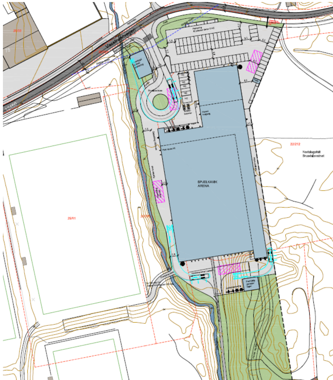
Figur 1-2 Utsnitt fra utomhusplan. Tegningen viser ny plassering av hallen. Utsnitt av tegning fra Olset as.
