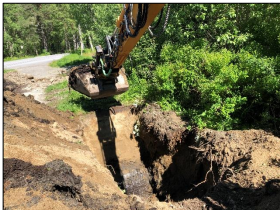
Figur 15 PG28. Overflatelag av sand, under dette mørke masser med innhold av avfall.
