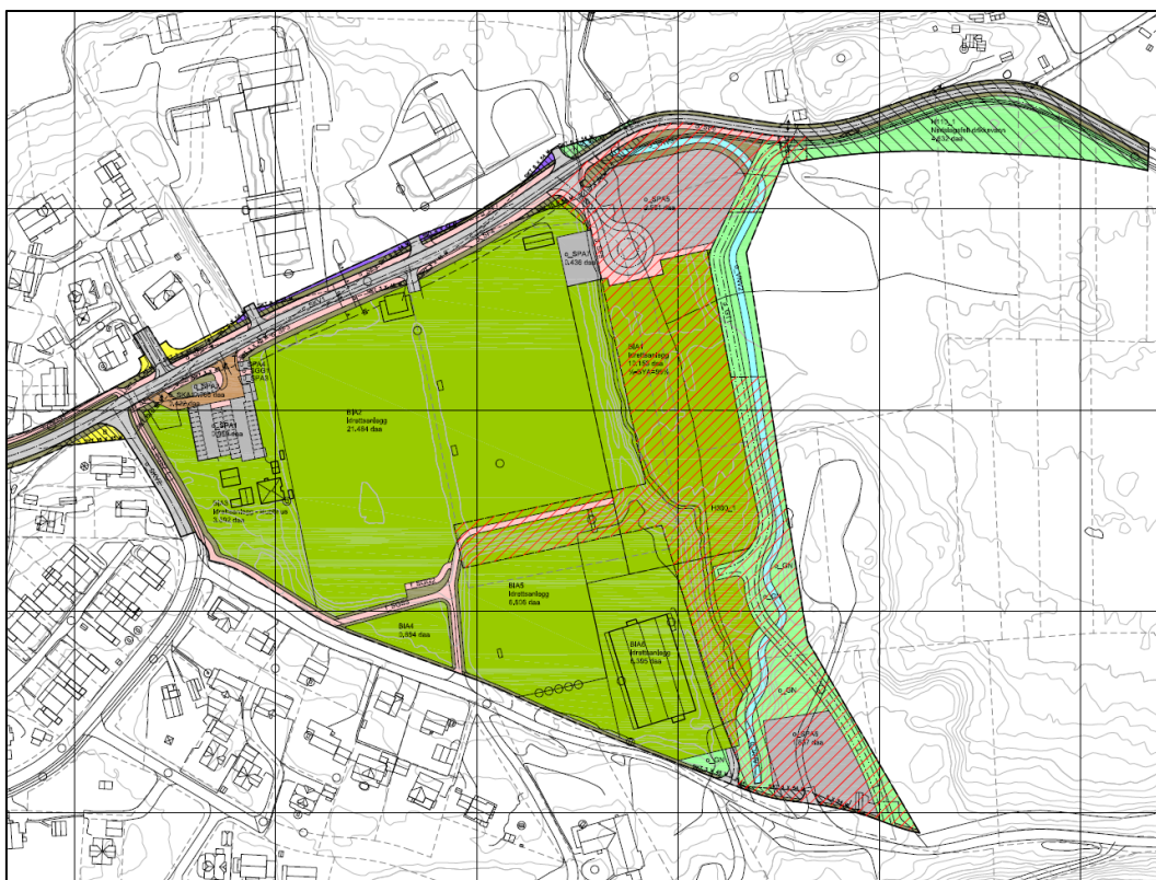
Figur 2 Utsnitt av plantegning. Hensynssone for «potensial for forurensa masse» vist med rød skravur.
