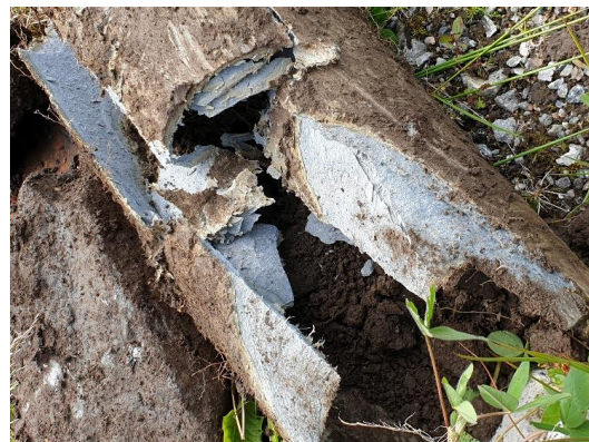
Figur 25 PG8. Antatt asbestholdige avløpsrør innblandet i massene.
