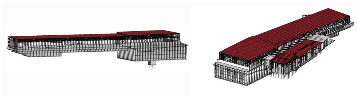
Illustrasjon – revit-byggmodellen med byggenes bærekonstruksjoner
