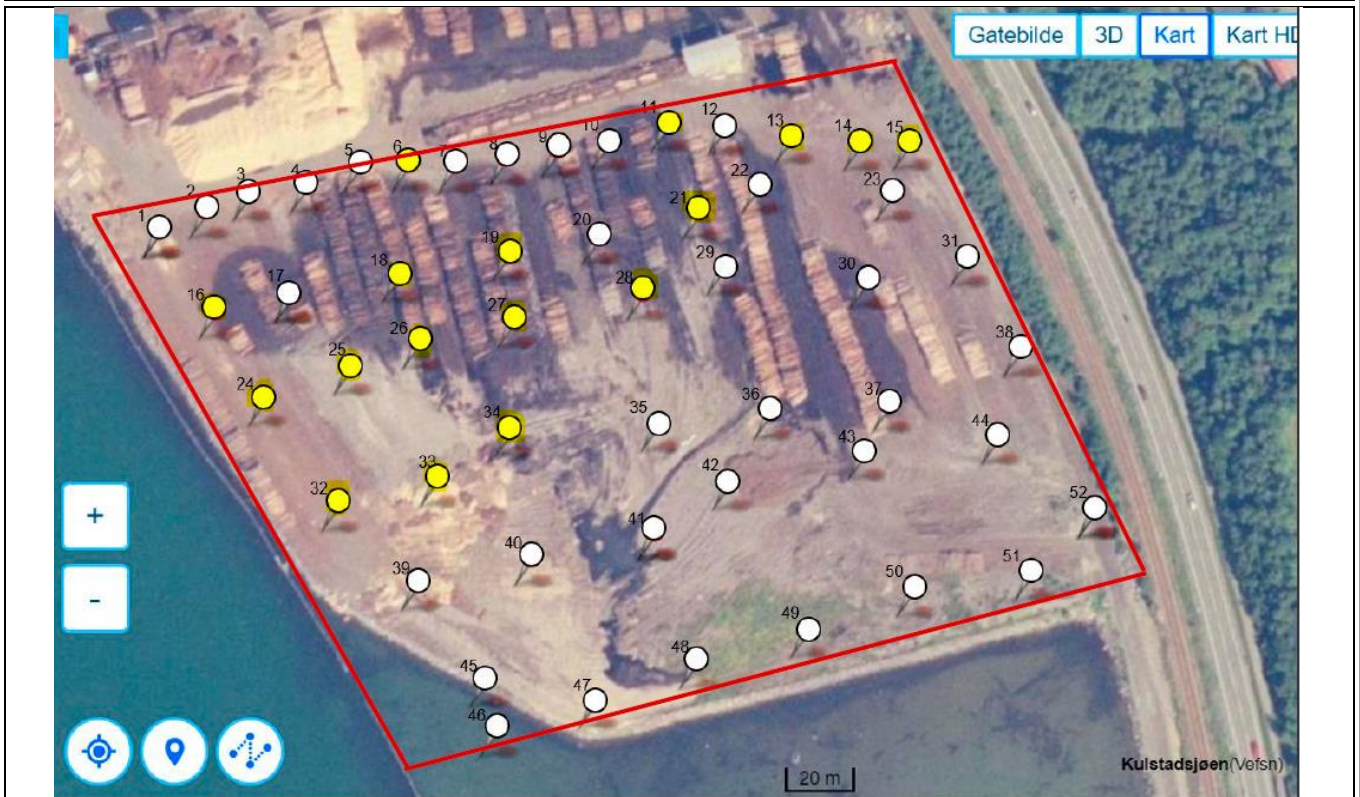
Figur 6: Viser plassering av TK (tiltaksklasse) 4 og 5 i topplag (<1m) (Utklipp fra Miljørapport september.2021).
