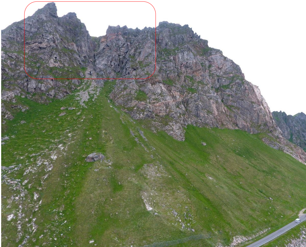
Figur 7. Oversiktsbilde over løsneområde for steinsprang, nordre (venstre) og søndre (høyre) kløft er synlige og klippepartiene på sidene av dem.
