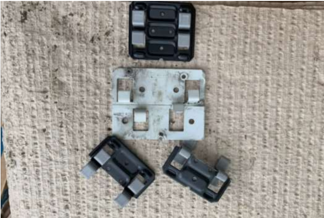
Foto 5: Her vises klips. Gammel klips i midten. Ellers hele og halve klips.
