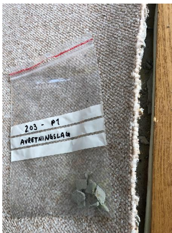
Bilde 8: Prøve 203 – P1, avretningslag under gulvteppe
