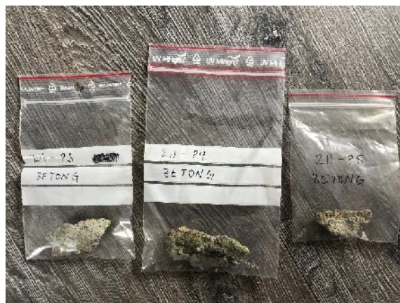
Bilde 22: Supplerende prøver av grunnmur med forhøyede verdier av Zn (Nr. 203), farlig avfall
