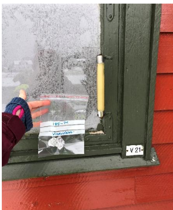
Bilde 1: Prøve 185 – P1, vinduskjett. Asbest ikke påvist
