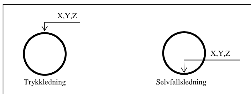
Figur 1. Måling av ledningshøyde.
