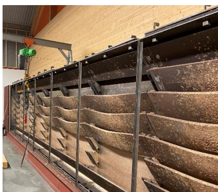
Figur 2: Kulefang uten frontplater og delvis demonterte sjalusi
