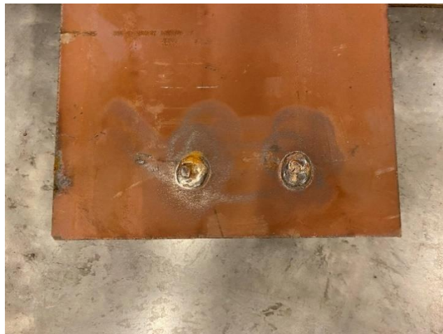
Figur 5: Stålsjalusi - forside med sveisede festepinner
