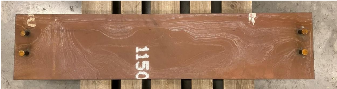
Figur 3: Stålsjalusi - bakside med festepinner
