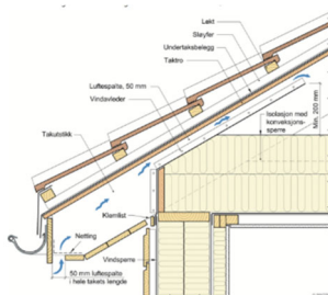
Fig. 73 Eksempel på overgang mellom yttrebygg og tak med takstoler og kaldt, luftet loftsson. For å unngå kondensering av kaldt luft i loftssonen bør vinddekkene avsluttes så langt innover på loftet at den horisontale avstøtningen blir så høy som mulig og med et isolasjonssjikt av minst 200 mm. Luftespalte i takbeleg bør være i hele bygnings lengde og plassert langt mulig fra yttrebygg.
