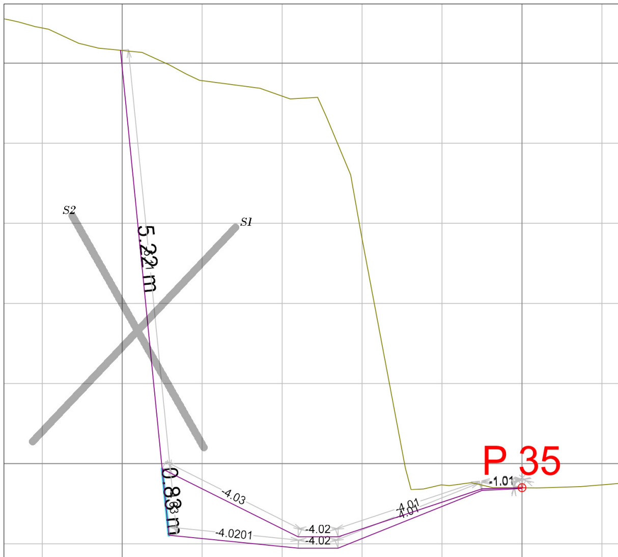
Figur 20: Del av tverrprofil BS12 som illustrerer viktigste strukturer mhp stabilitet. Ruter er 1x1 meter.
