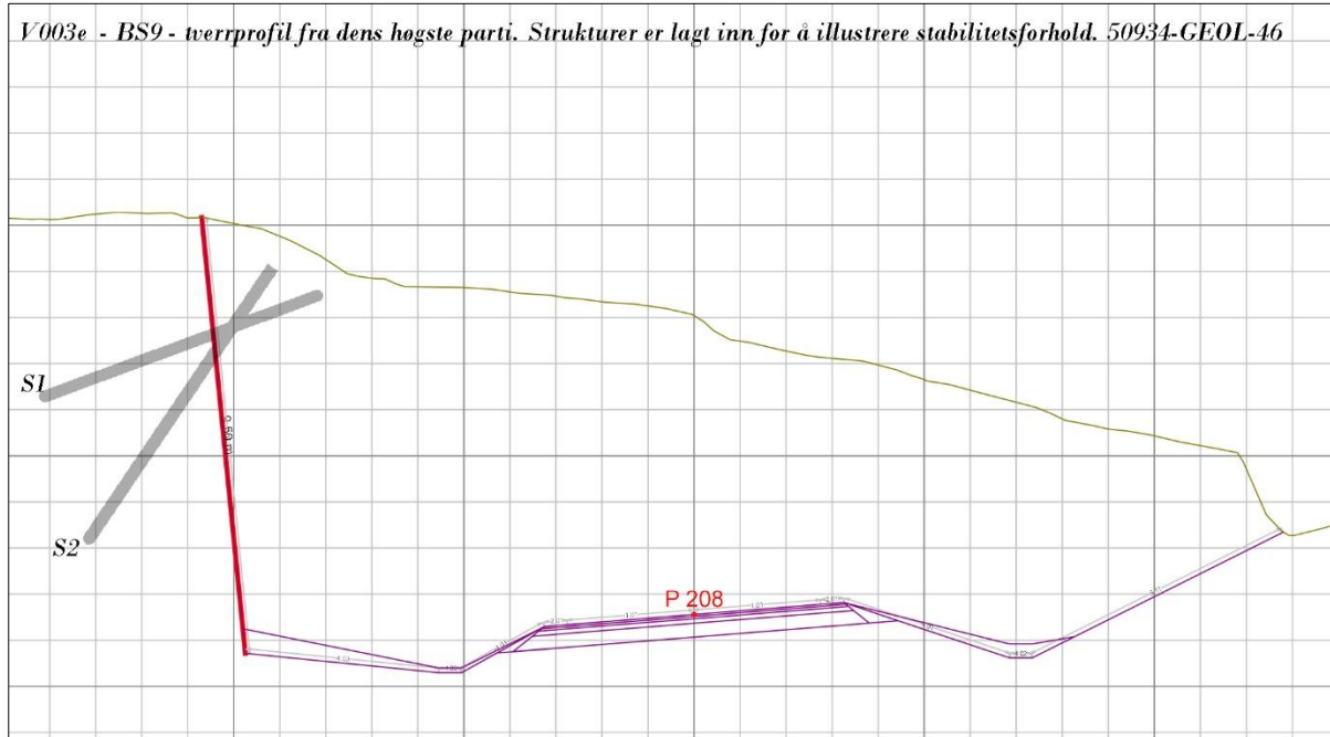
Figur 19: Del av tverrprofil BS9 som illustrerer viktigste strukturer mhp stabilitet. Rutene er 1x1 meter.
