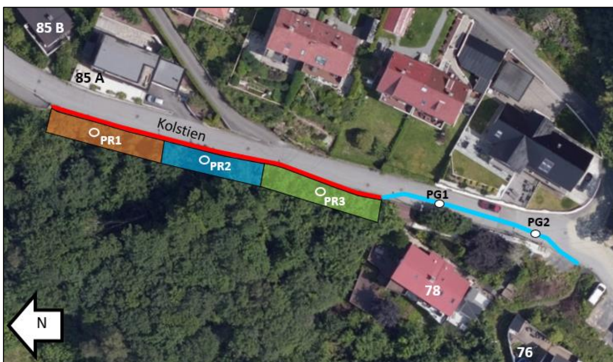
Figur 8-1: Figuren viser områder hvor det er påvist forurensning i løsmassene i skogen øst for veien. I nord (PR1) er det påvist forurensning i inntil tilstandsklasse 4, og i sør (PR3) er det påvist forurensning i tilstandsklasse 2. Løsmassene i og rundt PR2 anses som rene. PG1 og PG2 viser forslag til supplerende prøvepunkt i forbindelse med gravearbeidene.
