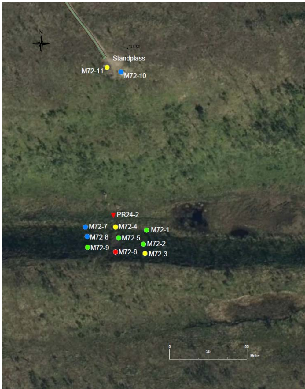
Figur 49 Prøvepunktene ved M72-banen fargelagt iht. høyeste tilstandsklasse for forurenset grunn, jfr. Miljødirektoratets veileder TA-2553/2009. Vannprøver er merket med trekant-symbol. Trekant med blå farge ligger under aktuelle grenseverdier for tungmetaller i vann. Vannprøver med rød farge overskrider grenseverdiene.
