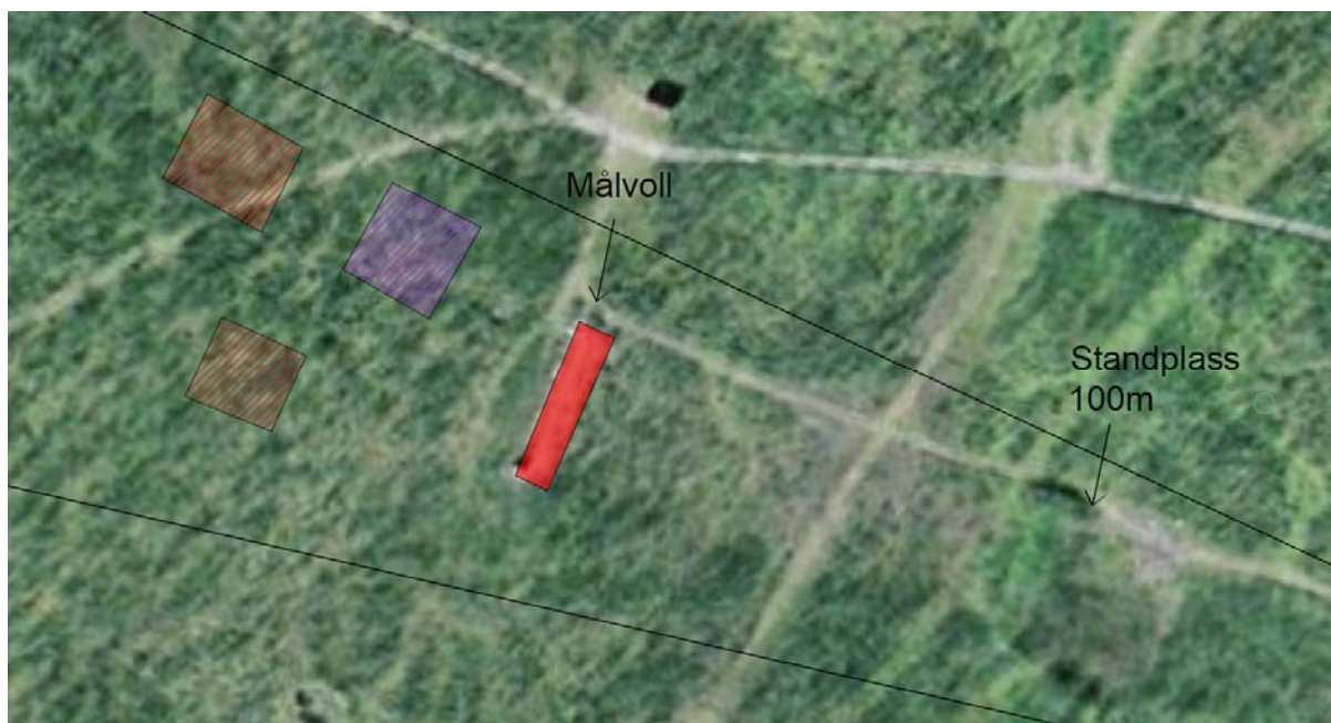
Figur 52 Tiltaksområder fargelagt iht. forurensningsgrad og generell trend for organisk innhold i massene. Masser i med blyinnhold 650-2500 mg/kg er angitt med rød farge, mens masser >2500 mg/kg er vist med lilla farge. TOC-innhold < 5% er vist med heltrukken farge, mens masser >10% er vist med skravur.
