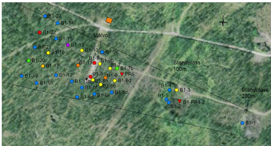
Figur 20 Situasjonsplan for bane 1 – gammel skoleskytebane. Prøvepunktene er fargelagt iht. høyeste tilstandsklasse for forurenset grunn, jfr. Miljødirektoratets veileder TA-2553/2009. Vannprøver er merket med trekant-symbol. Trekant med blå farge ligger under aktuelle grenseverdier for tungmetaller i vann. Vannprøver med rød farge overskrider grenseverdiene.
