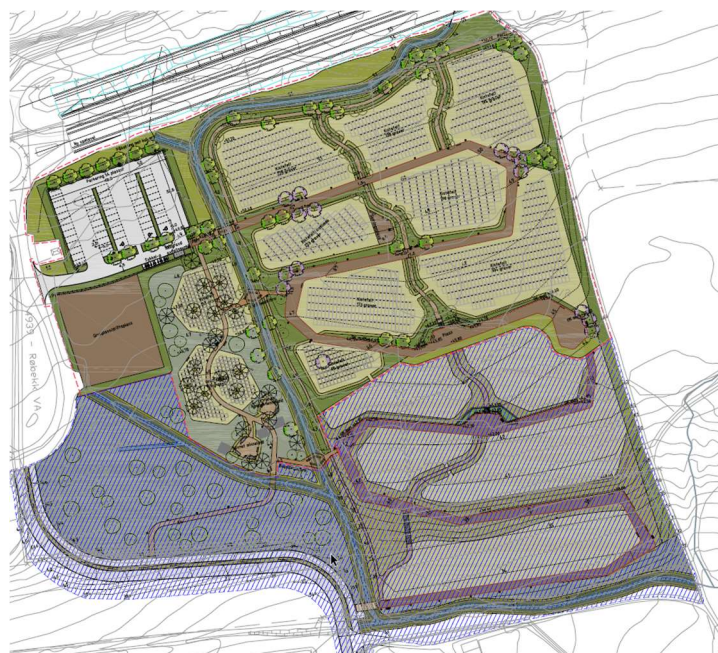
Figur. Skravering viser grensen mellom byggetrinn 1 og 2
