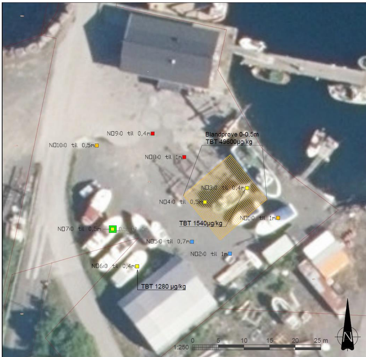
Figur 3 Oversikt over høyeste påviste tilstandsklasse i sjaktprøvene. Fargekodet iht. Miljødirektoratets veileder TA 2553/2009. Skravert område markerer område hvor det ble tatt ut blandprøve av toppmasser fra 0-5 cm, hvor resultatet viste masser i tilstandsklasse 4.
