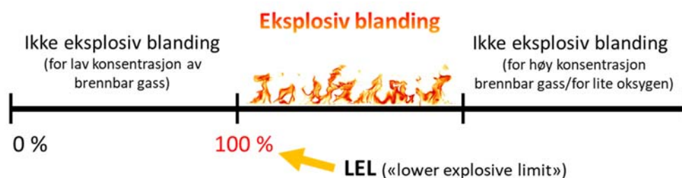
Figur 5: Skjematisk fremstilling av eksplosjonsgrense. LEL er laveste konsentrasjon av en brennbar gass, som kan antennes i luft.
