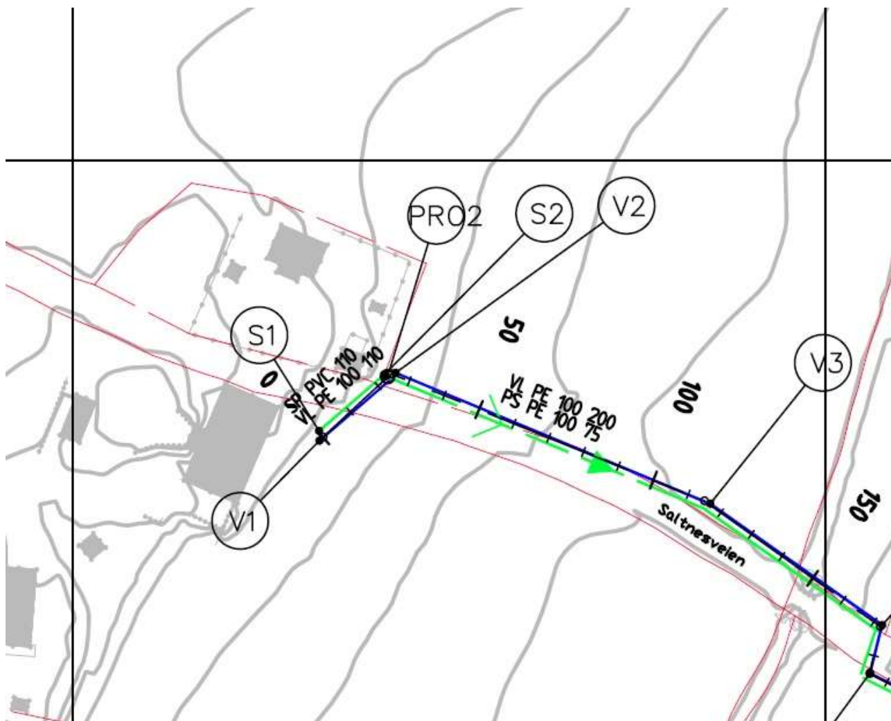
Figur 1 Plassering av pumpestasjon (Pro2)
