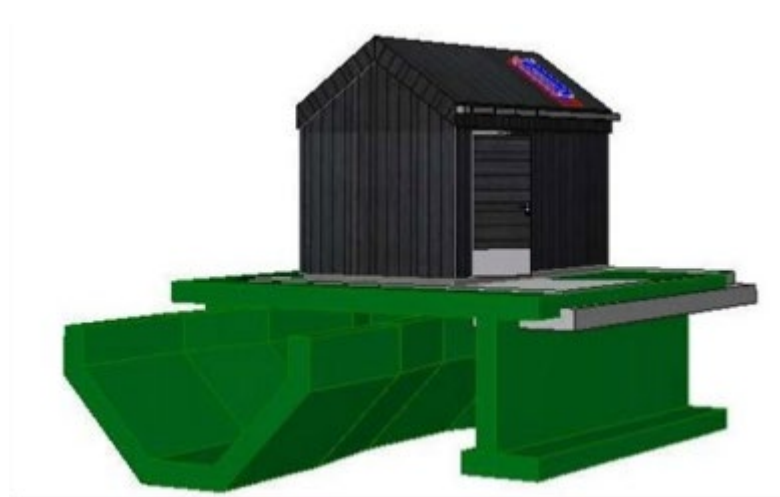
Figur 3: Mulig utforming av hydrologisk profil (her inkludert med målehytte over profilen) for illustrasjon.
