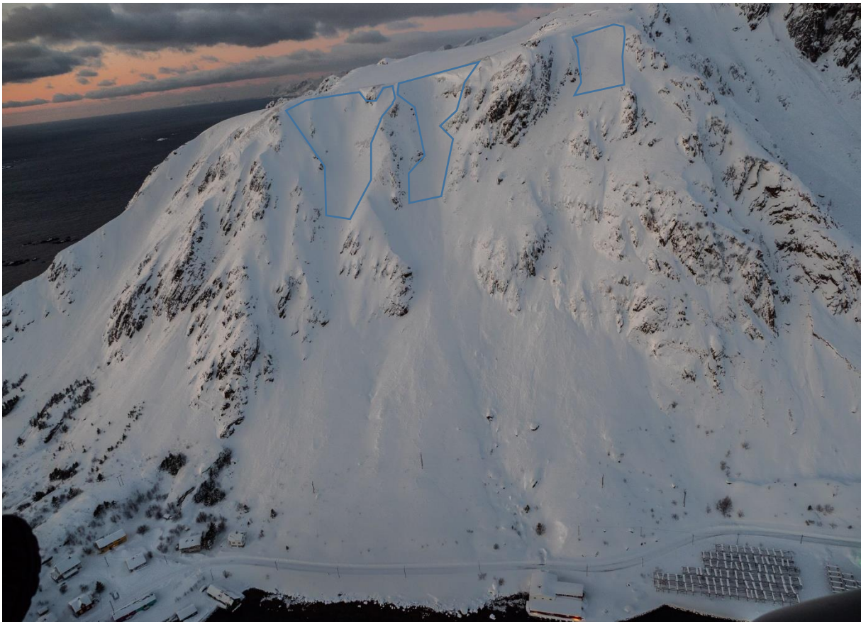
Figur 9: Bilde tatt fra helikopter i slutten av januar 2019, da det kom mye snø på kort tid og det gikk flere snøskred i området. De mest aktuelle løснеområdene er grovt skissert. Foto: Odd-Arne Mikkelsen, NVE
