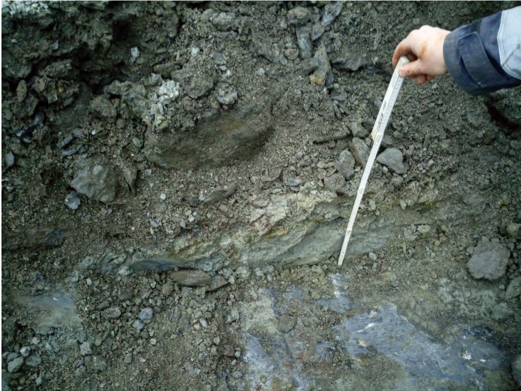
Bilde B3. Nærbilde prøvegropp P1. Ca. 0,8m graving til berg. Berg observert å være fyllitt.
