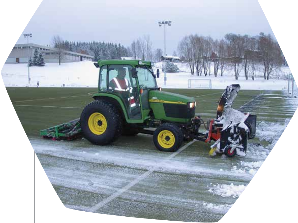
Frontmontert snøfres og bakmontert hydraulisk slådd.
