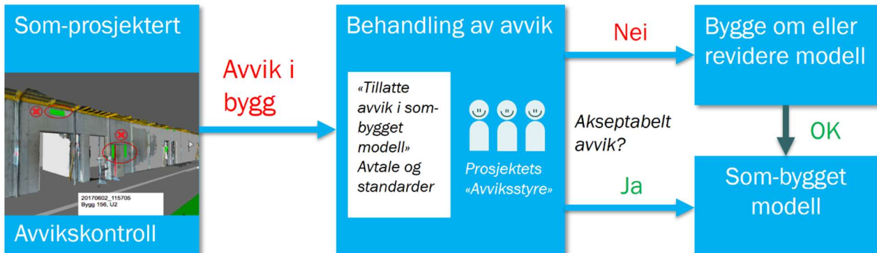
Figur 6: Arbeidsflyt for BIM fra som-prosjektert til som-bygget
