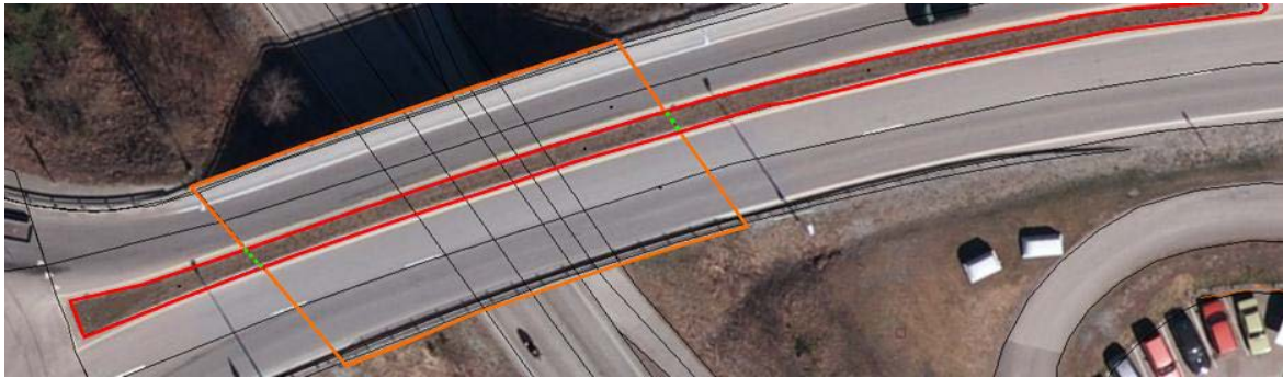
Figur 6. Eksempel på registrering av trafikkøye som delvis ligger på bru. Her er det benyttet VegkantFiktiv (grønn stiple) for å avgrense delen av trafikkøya som ligger oppe på brua (MEDIUM L) (Kilde: Kartverket).
