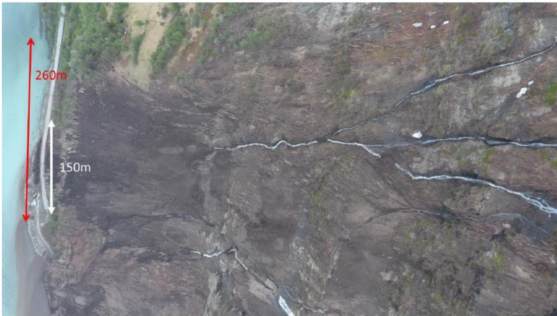
Figur 3: Den 1. juni 2020 gikk det et stort skred som berørte ca. 250 meter av vegen. Det er 20 - 30 år siden sist et så stort skred traff vegen sist. For mer info om skredet:
