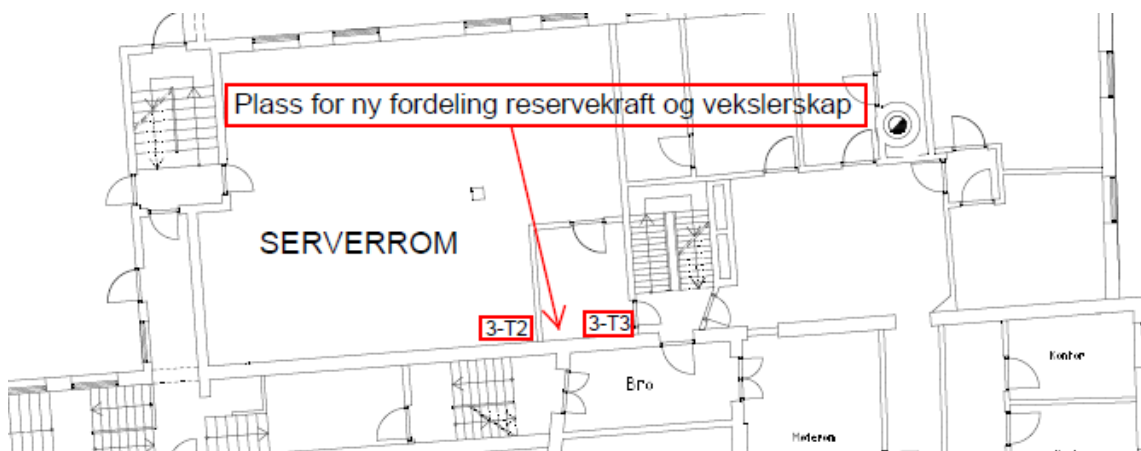
Figur 4, plassering av eksisterende tavler og nye vekslerskap.
