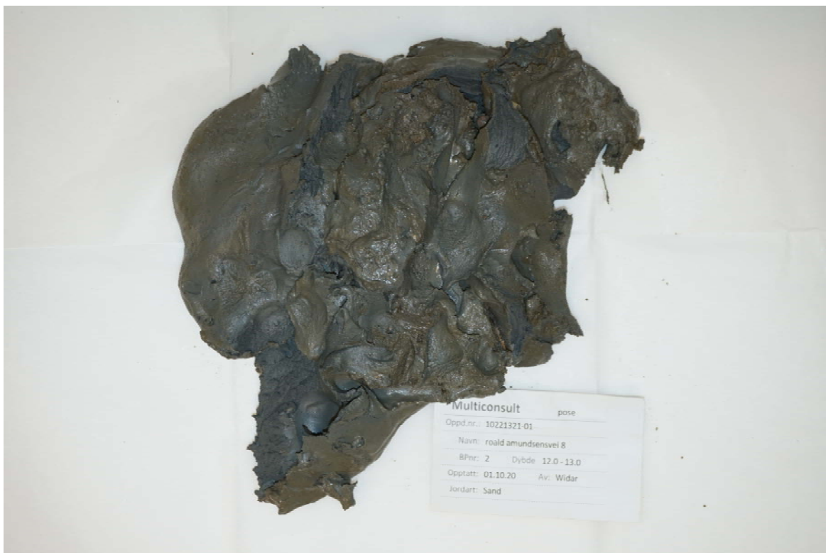
Figur 7: Løsmasser fra borpunkt 2, 12,0-13,0 m dybde.
