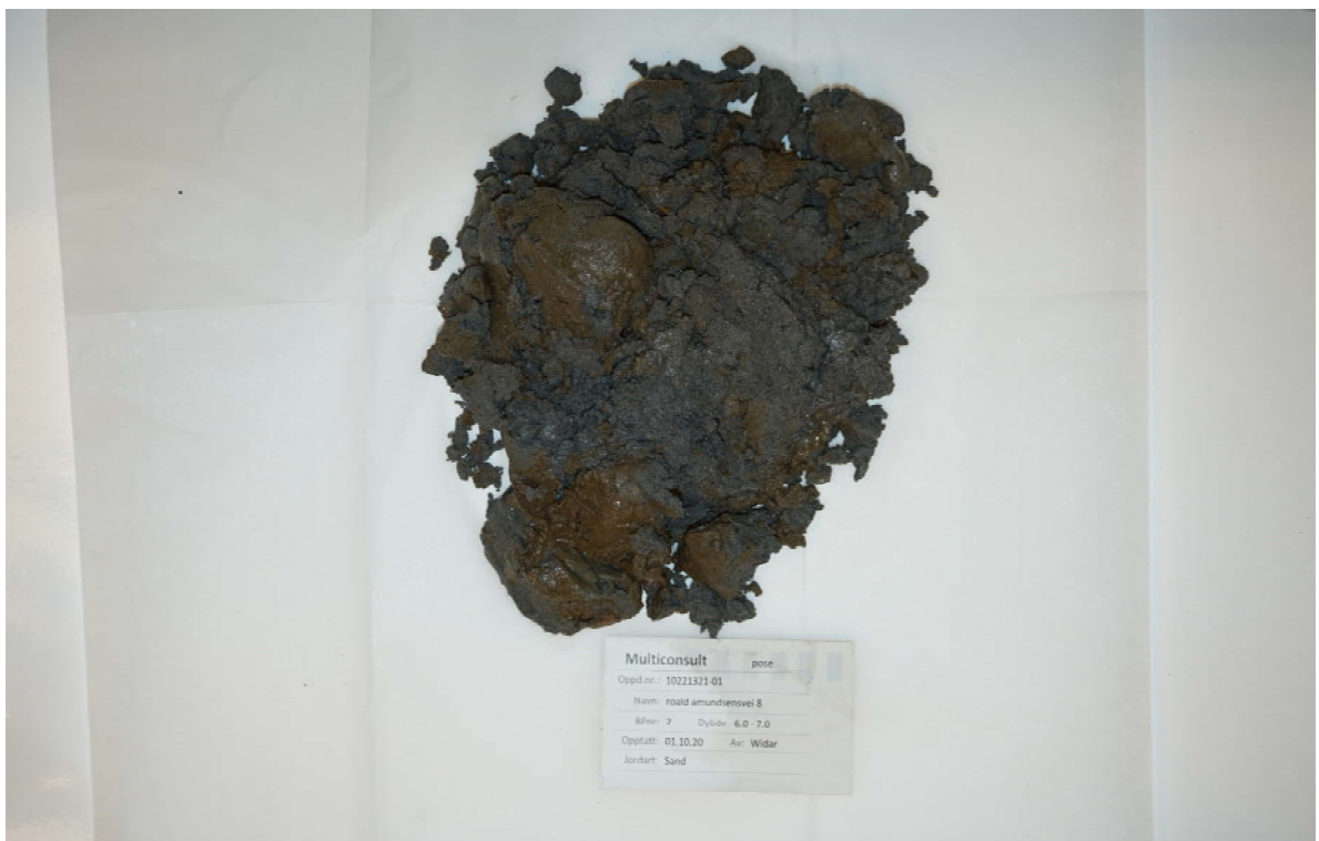
Figur 6: Løsmasser fra borpunkt 2, 6,0-7,0 m dybde.
