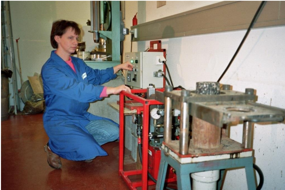
Bilde 7.1 Tillaging av prøver med statisk presse
