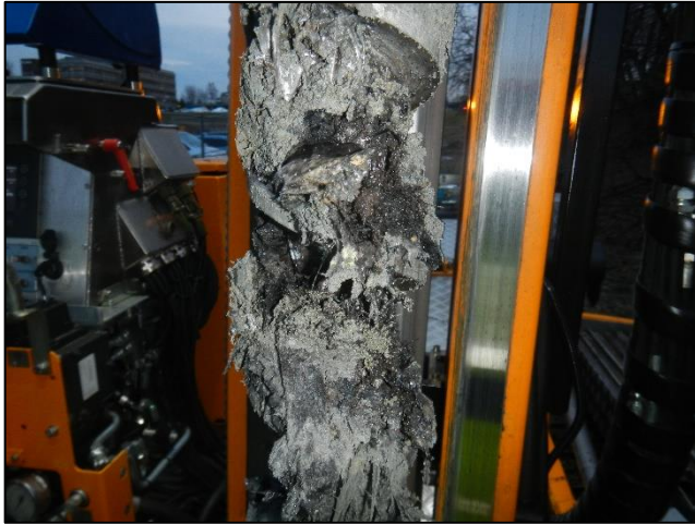
Figur 8 Bilde fra prøvepunkt VS27A. Avfall (plast og treverk) i masser av jord/sand/leire.
