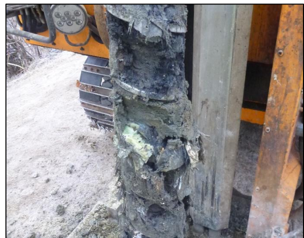
Figur 11 Bilde fra prøvepunkt VS14B 5,3-6 meter. Avfall (plast og tre) i masser av sand/leire.
