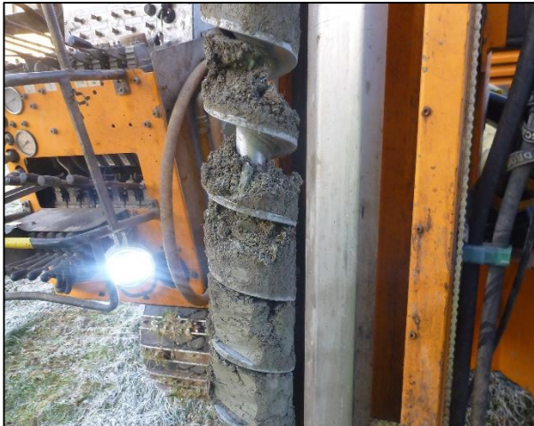
Figur 16 Bilde fra prøvepunkt SK16 0-1 meter. Jord/leire/grus over leire.
